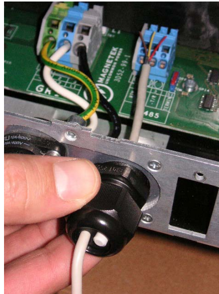
Fig. 16: Fig. 16 - Câblage RS-485
