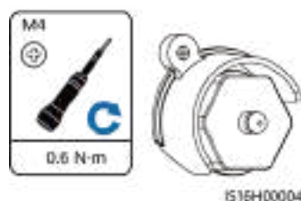
Figure 5-37 Installation des composants antivol du Smart Dongle
