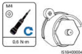
Figure 5-35 Installation des composants antivol du Smart Dongle
